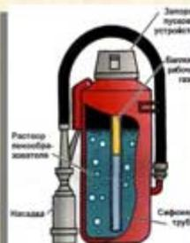
ПРИНЦИП ДЕЙСТВИЯ основан на вытеснении раствора пенообразователя избыточным давлением рабочего газа. При срабатывании запорно-пускового устройства прокалывается заглушка баллона с рабочим газом. Пенообразователь выдавливается газом через каналы и сифонную трубку. В насадке пенообразователь перемешивается с засасываемым воздухом, и образуется пена.
